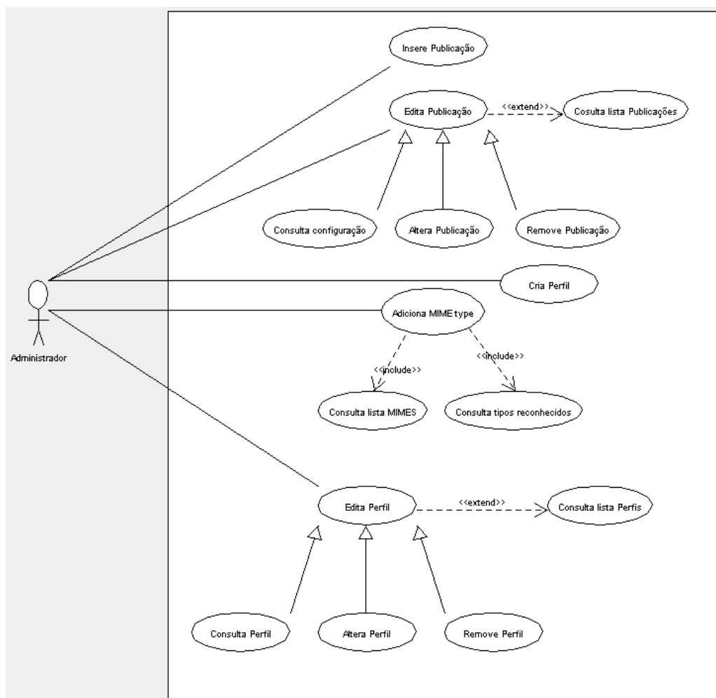
Figura 3.1 Diagrama de casos de uso – UML. Casos de uso disponibilizados pela interface web a um utilizador humano quando este efectua a configuração do sistema.
